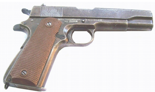
P.A. REMINGTON modèle U.S. 1911 A1 calibre .45 ACP. (arme alliée). Concepteur, John Moses BROWNING licence COLT. Utilisation : seconde guerre mondiale, Indochine, plus rarement en Algérie.
