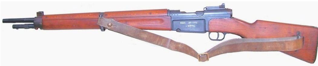
F.R. M.A.S. modèle 1936, (1 er modèle) calibre 7,5mm. Utilisation : seconde guerre mondiale, guerres d'Indochine et d'Algérie.
