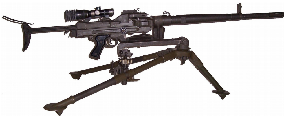
Mitrailleuse MAC modèle A.A. N F1 calibre 7,62mm N qui succède à l'A.A. 52 de calibre 7,5mm. Elle peut être utilisée à terre avec son bipied et sa béquille ou sur son affût U.S. M2 MF 52 et avec une lunette A.P.X. L 806 du même modèle que celle des F.S.A. M.A.S. 1949 et 1949-56 mais avec un support spécial. Utilisation : guerre d'Algérie pour l'A.A. 52, OPEX pour l'A.A. N F1.
