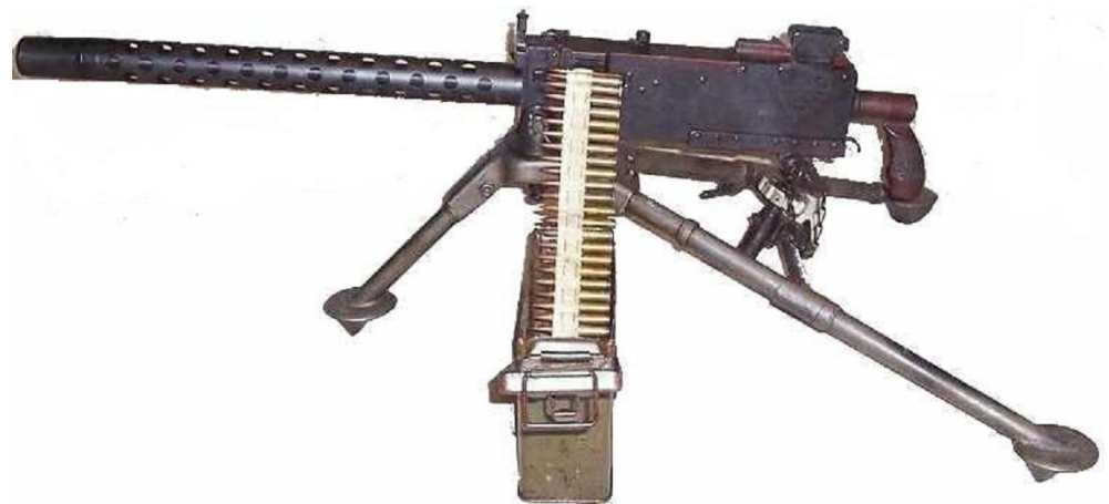
Mitrailleuse B.M.G. U.S. modèle 1919 A4 calibre .30-06 sur affût trépied U.S. M2. (arme alliée). Concepteur, John Moses BROWNING. Utilisation : seconde guerre mondiale, guerres d'Indochine et début d'Algérie.
