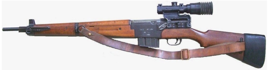
F.S.A. M.A.S. modèle 1949 calibre 7,5mm. Utilisation : guerres d'Indochine et d'Algérie, certains avec lunettes A.P.X. L 806 pour tireursélite.
